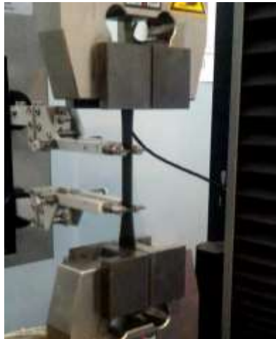
Gambar 4 Pengujian kuat tarik benda uji CFRP Sumber: I. H. Ismadi dan G. Nugroho (2020)
