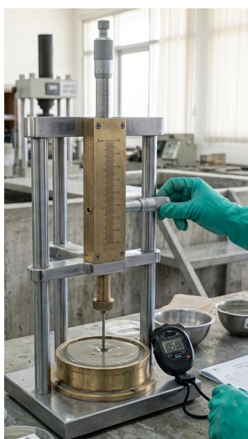
Gambar 7. Pengujian setting time menggunakan alat Vicat
