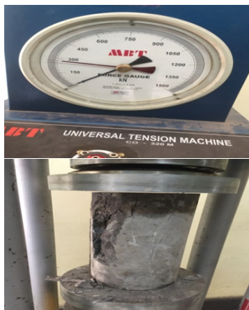
Gambar 6. Pengujian kuat tekan menggunakan CTM
