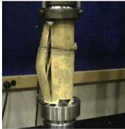
Gambar 6. Uji Tekan Bambu (Sumber: Eratodi, 2017)
