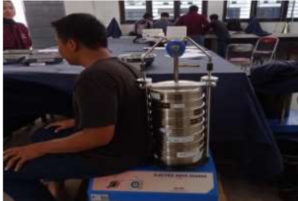
Gambar.4 Proses Menggucang Benda Uji Menggunakan Sieve shaker
