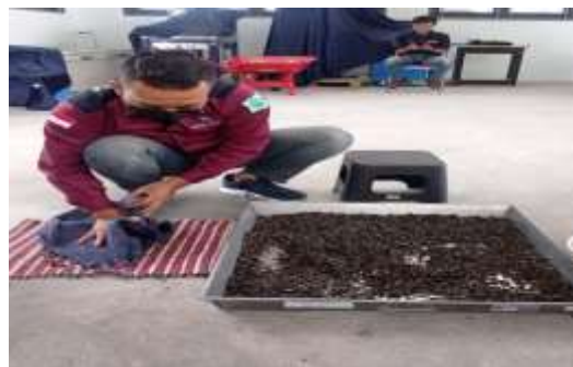
Gambar.12 Mengelap Menggunakan Kain Agar Benda Uji SSD
