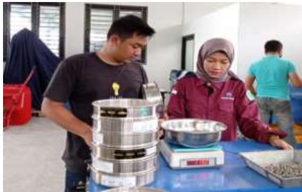
Gambar .5 Proses Menimbang Benda Uji Yang Tertahan Disetiap Ayakan
