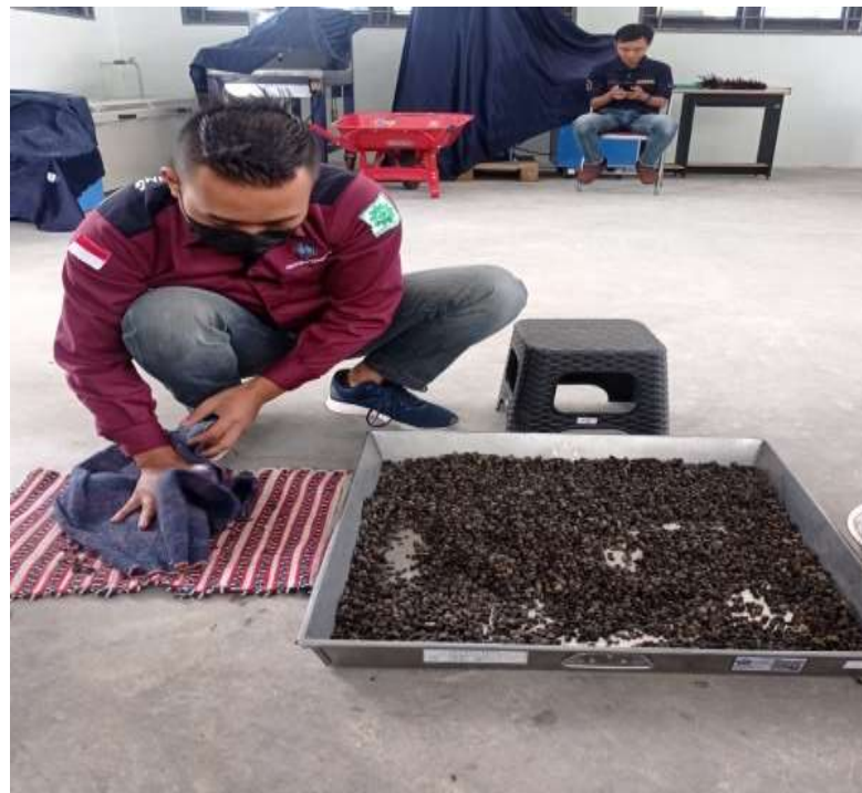
Gambar 14 Mengelap Menggunakan Kain Agar Benda Uji SSD
