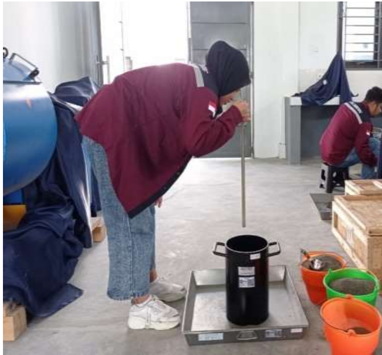
Gambar 10 Pengujian Berat Isi Padat
