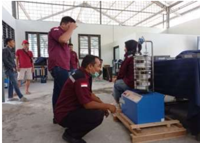
Gambar 6 Proses Menggucangkan Benda Uji Menggunakan Sieve shaker
