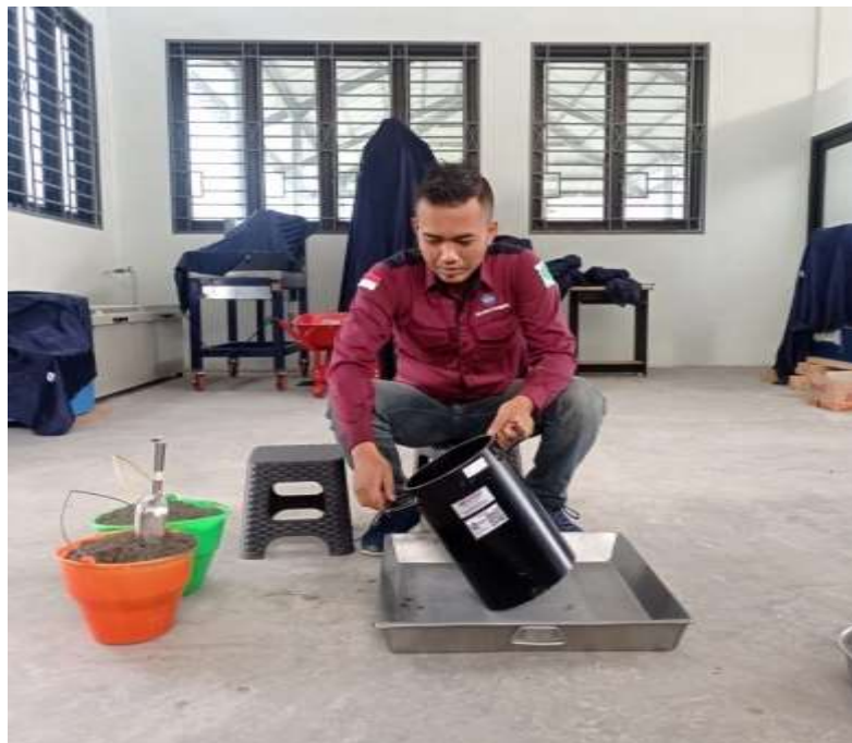
Gambar 11 Pengujian Berat Isi Ketuk
