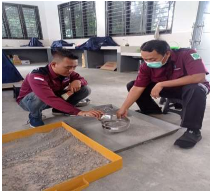
Gambar 18 Mengayak/Memisahkan Benda Uji setelah Abrasi Menggunakan Saringan No. 12
