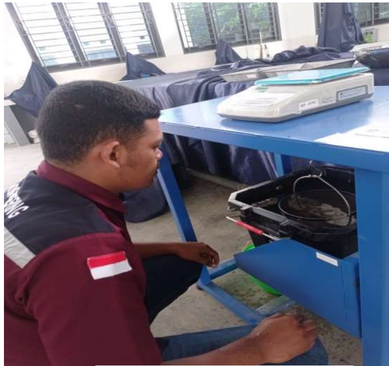
Gambar 15 Menimbang Benda Uji
