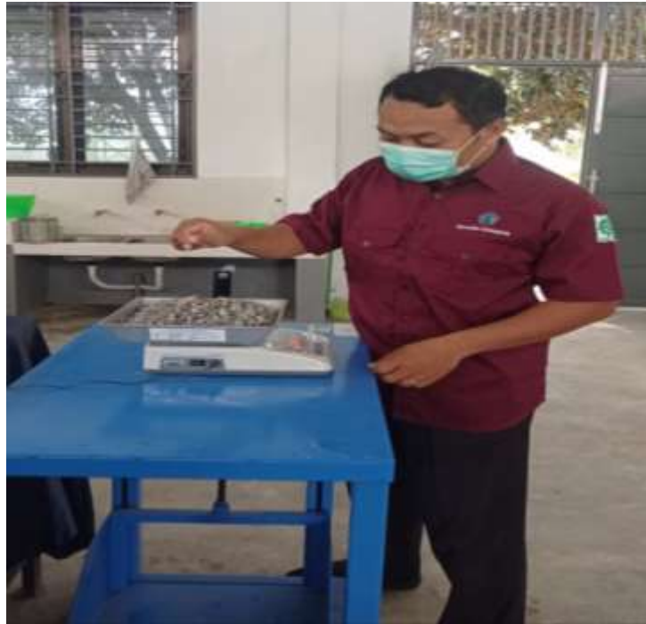
Gambar 12 Menimbang Benda Uji
