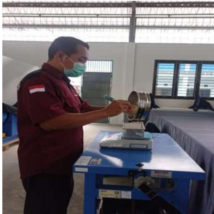
Gambar 8 Proses Menimbang Benda Uji Kedalam Talam
