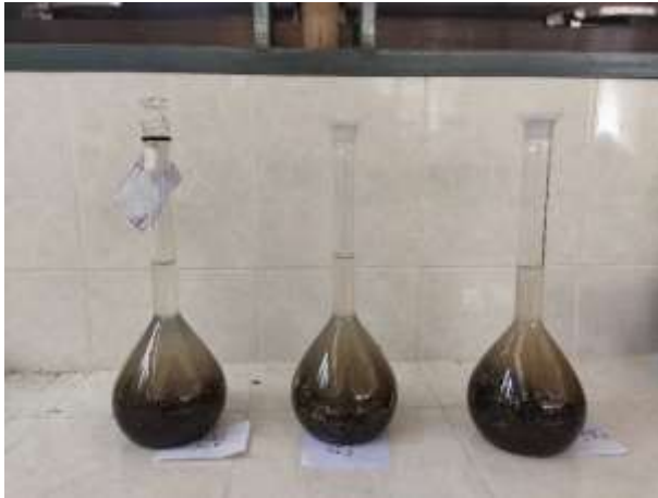
Gambar 14. Benda Uji dalam Piknometer
