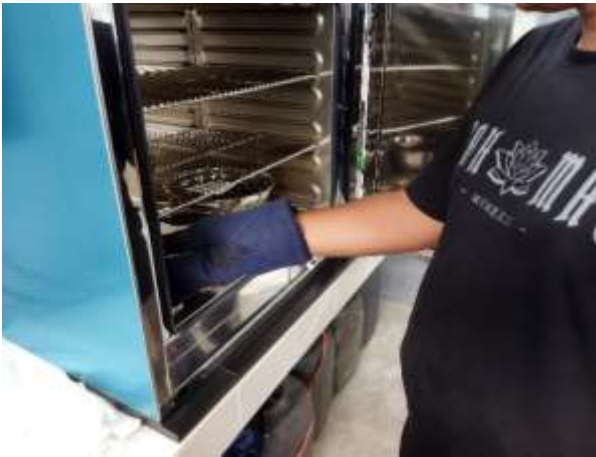
Gambar 8. Pengeringan Benda Uji dengan Oven
