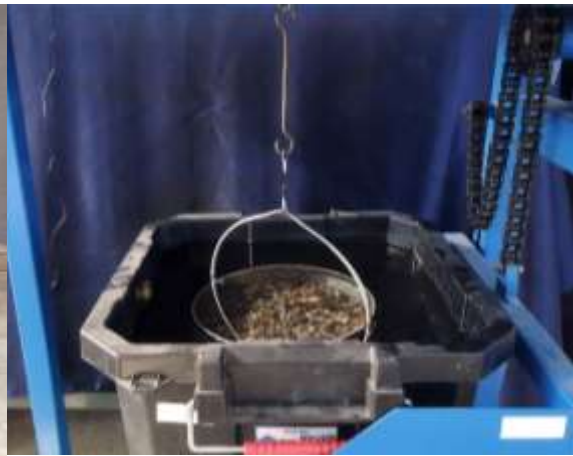
Gambar 17. Penimbangan Benda Uji dalam Air
