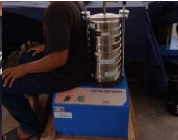
Gambar 9. Proses Pengguncangan dengan Sieve Shacker
