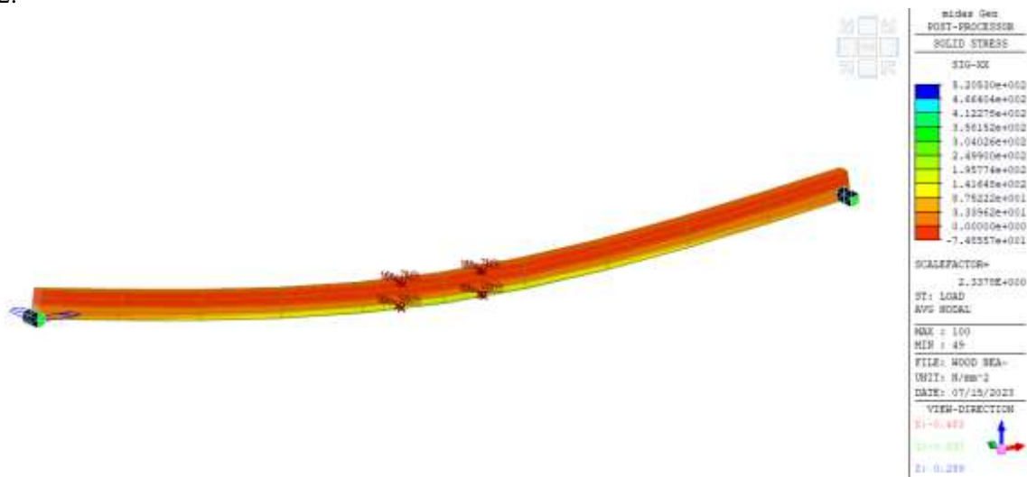
Gambar 4.1 Analisis solid element tegangan lentur ultimate pada balok kayu sengon dengan menggunakan perkuatan CFRP
