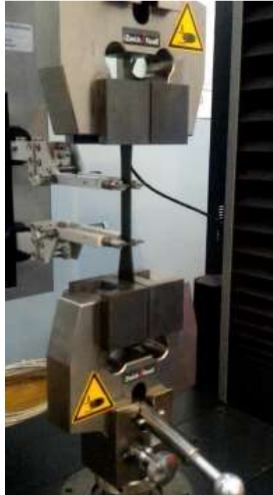
Gambar 2.4 Pengujian kuat tarik benda uji CFRP Sumber: I. H. Ismadi dan G. Nugroho (2020)
