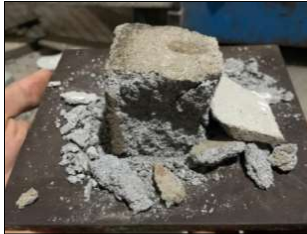
Gambar 1. Hasil Pengujian Kuat Tekan Mortar
