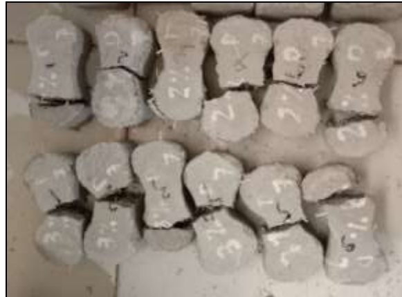
Gambar 5. Hasil Pengujian Kuat Tarik Aksial Mortar
