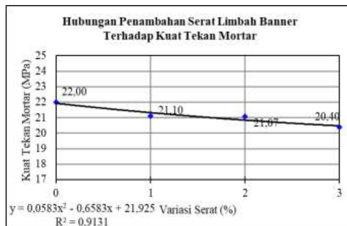
Gambar 2 Grafik Hasil Pengujian Kuat Tekan Mortar
