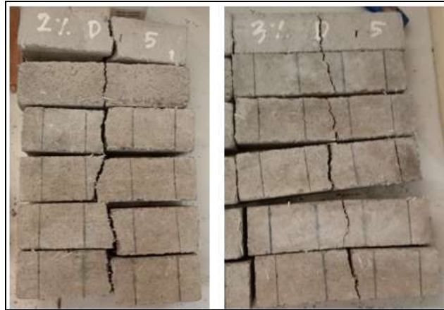
Gambar 3. Hasil Pengujian Kuat Lentur Mortar
