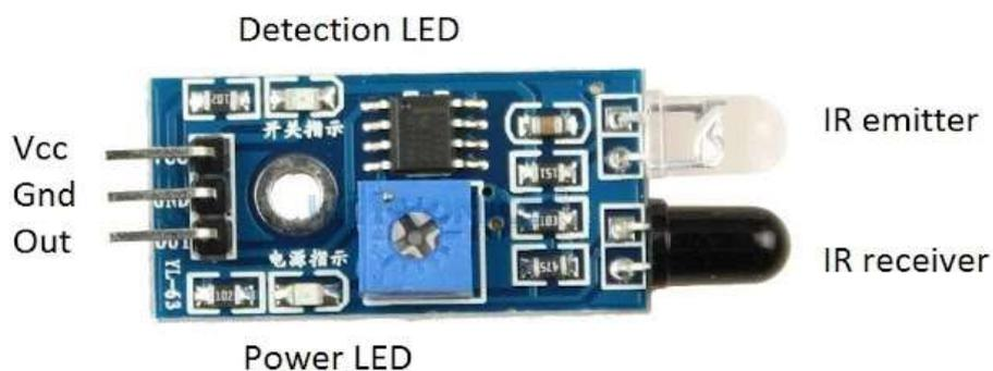
Gambar 6. Sensor Inframerah
