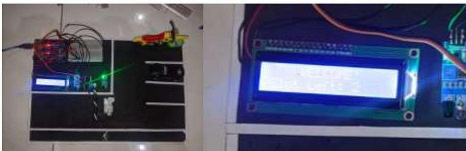
Gambar 11. Tampilan layer lcd yang berubah karena ada kendaraan terparkir
