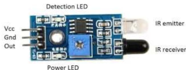
Gambar 5. Sensor Inframerah
