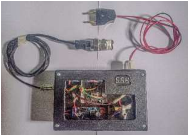
Gambar 12. Tampilan Alat Pemantau Tekanan Air Jarak Jauh Berbasis Pressure Transducer
